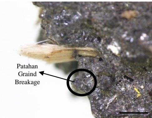
Gambar 4.3 Lipro Setelah Uji Impact (Bentuk Patahan)
