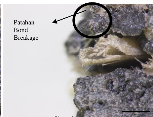
Gambar 4.5 Celup Setelah Di Uji Impact (Bentuk Patahan)
