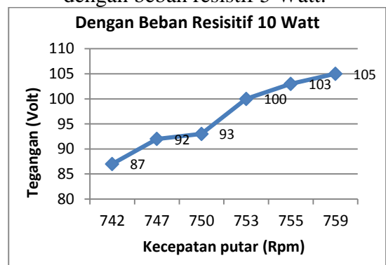
Gambar 13. Hubungan kecepatan putar terhadap tegangan pada generator induksi dengan beban resistif 10 Watt.
