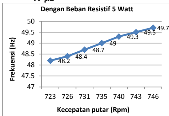
Gambar 9. Hubungan kecepatan putar terhadap frekuensi pada generator induksi dengan beban resistif 5 Watt.
