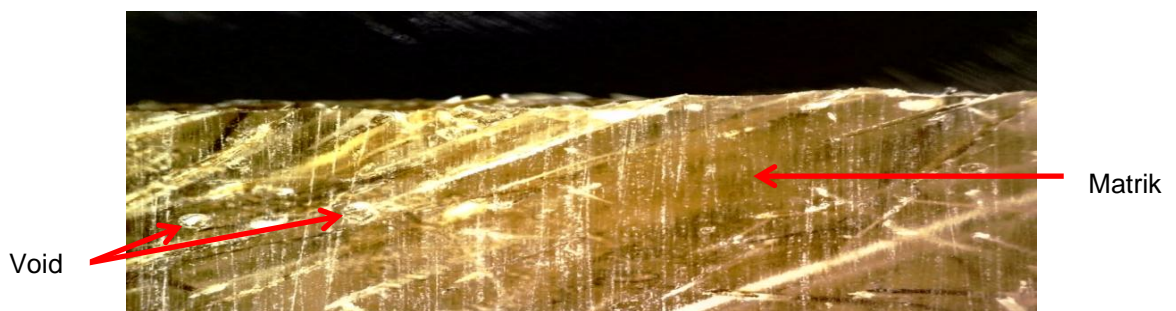
Gambar 15. Foto makro patahan perbesaran 50 kali pada spesimen komposit yang diperkuat serat dengan pengaruh 5% NaOH
