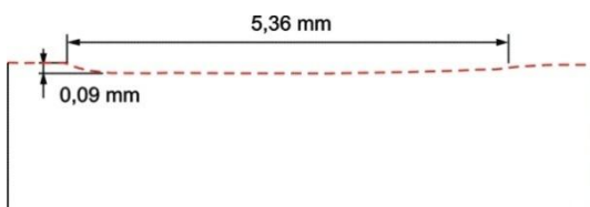
Gambar 8. Foto makro profil dinding bawah dengan arus 0,09 A
