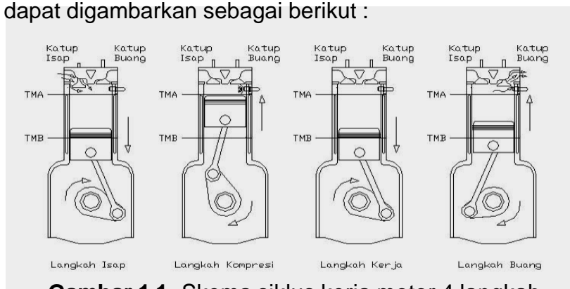
Gambar 1.1. Skema siklus kerja motor 4 langkah
