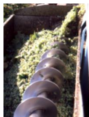
Figura 7 – Orgão de armazenamento: Parafuso semfim num tegão lateral (adaptado de Lopes, 2012).
