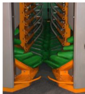
Figura 4 - Vista frontal da cabeça de colheita, observando-se os sacudidores e os órgãos de recepção (adaptado de Lopes, 2012).
