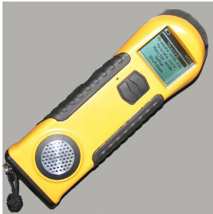
Figura 21. Susceptibilímetro portátil (KT-10) do Departamento de Geociências, Ambiente e Ordenamento do Território (DGAOT, FCUP).
