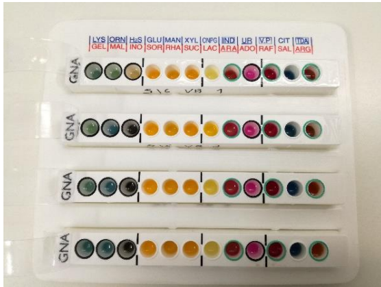
Figura 17 – Exemplo da galeria de identificação utilizada para a identificação de Salmonella sp. (Fonte: Autor)
