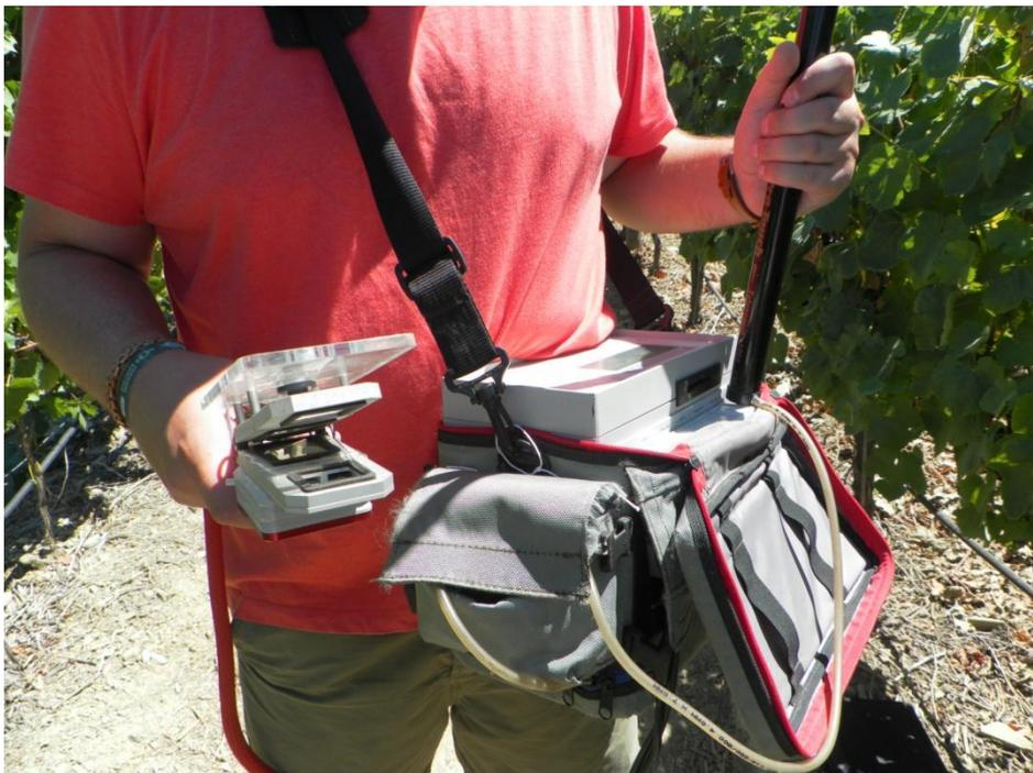
Figura 13 - Equipamento IRGA (*Infrared gas analyser*). Quinta da Cabreira, 5 de Agosto de 2016.
