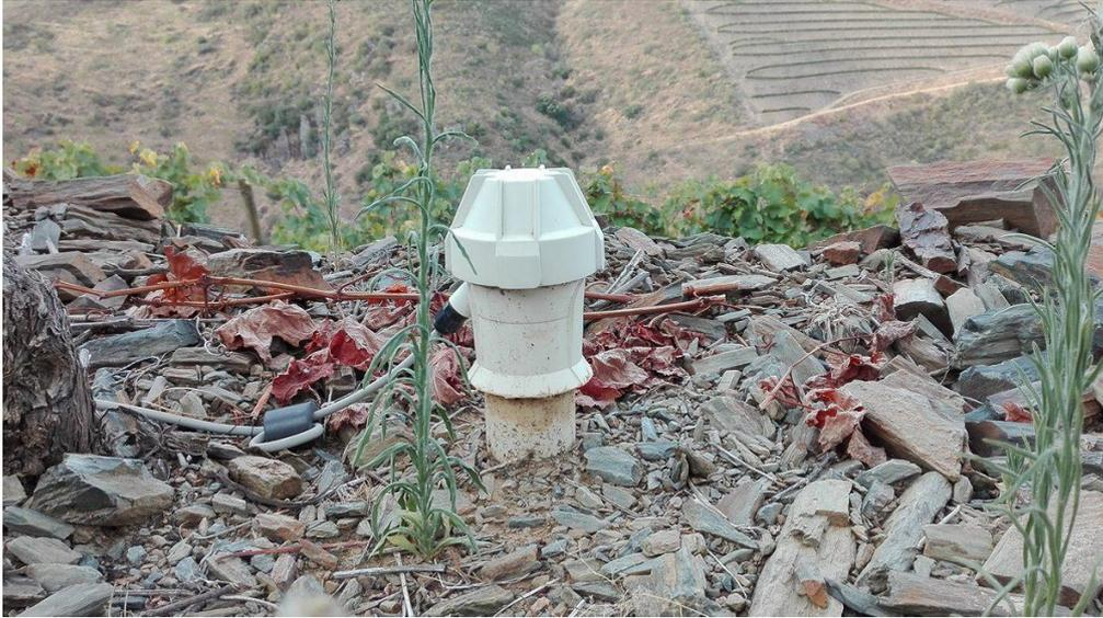
Figura 8 - Sonda EnviroSCAN® 150 para monitorização da humidade do solo. Quinta da Cabreira, 2016.
