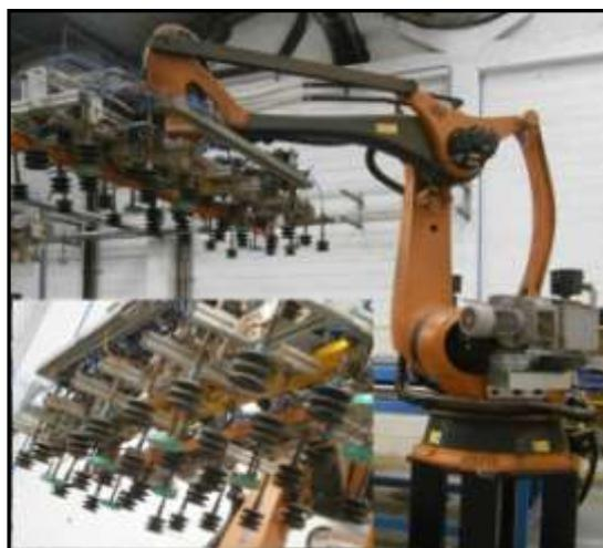
Figura 18 - Ferramenta de alimentação do Robô 1
