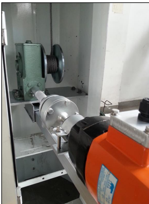
Figura 3.6 – Acionamento por motor móvel da empresa Feiteng, in http://www.feiteng.com.cn/doce/pro_detail.asp?P_ID=84&c_ID=11&prname=Drive%20Motor&prname1=Protatable%20drive&prname2=&index_x=2 , consultado em 2016-10-19, 13:05.
