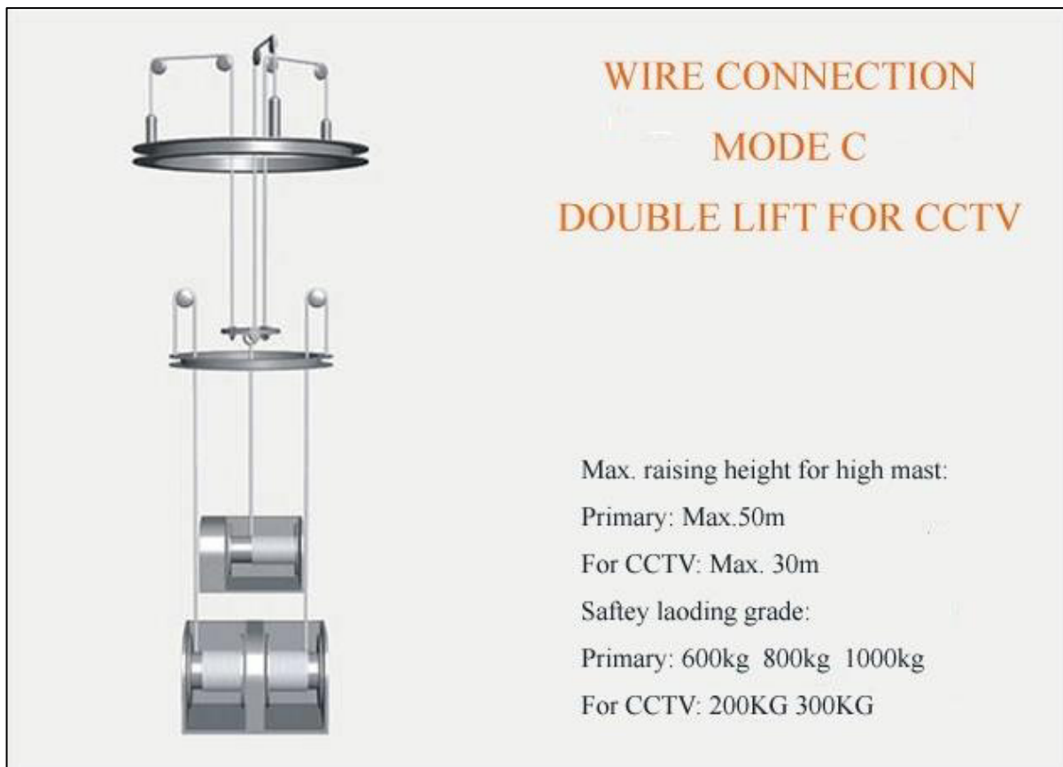
Figura 3.3 - Sistema de elevação da empresa Feiteng com dois sistemas de elevação independentes, in http://www.feiteng.com.cn/doce/rcxx.asp?index_x=2 , consultado em 2016-10-19, 12:12.
