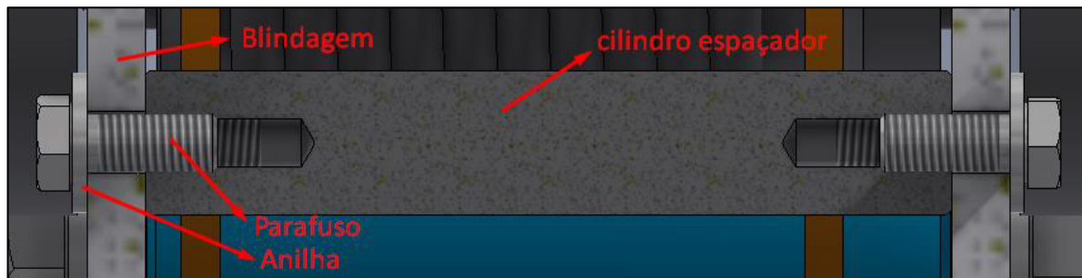
Figura 4.57 – Ilustração da fixação dos cilindros espaçadores.
