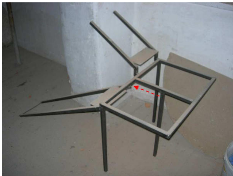
Figura 27 – Maquete, com a deslocação de um apoio da escadaria metálica
