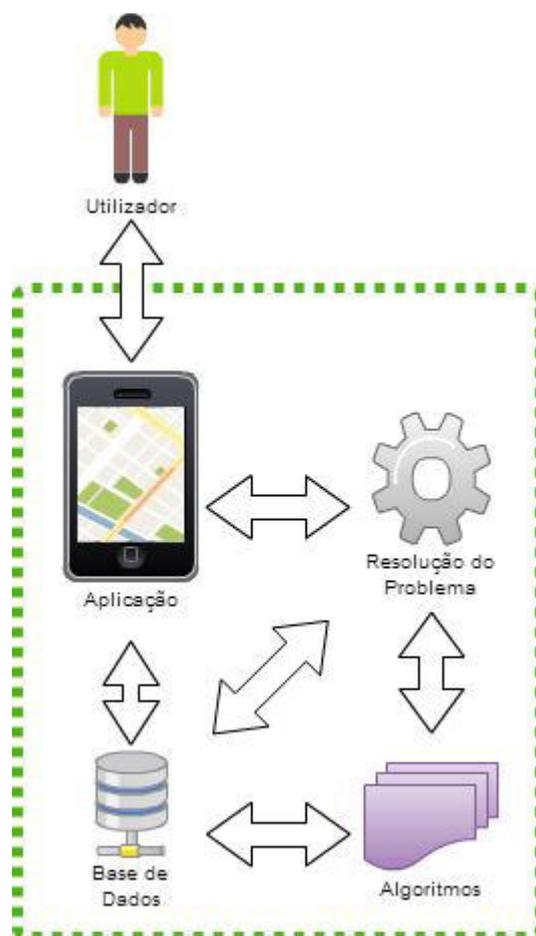
Figura 5 – Arquitetura do sistema desenvolvido
