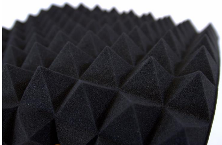
Slika 4.2: Primer panela poroznega absorberja umetne mase, ki se uporablja v prostorih za zmanjševanje akustičnega odmeva [28]
