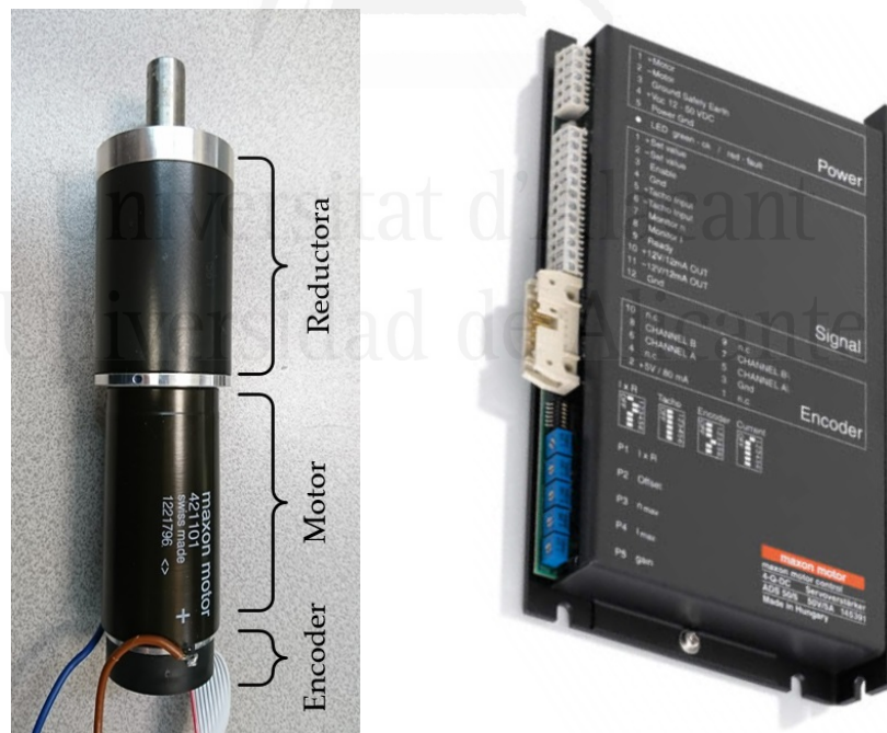
Figura 3.8 Conjunto Motor-Reductora-Encoder de Maxon (Izquierda) y amplificador ADS50/5 usado para controlar los motores (Derecha).
