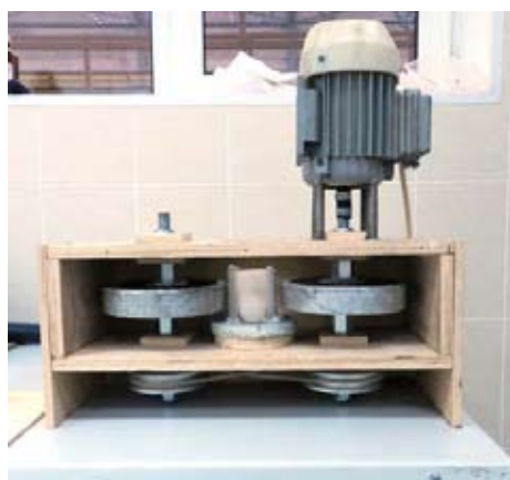
Рис. 2. Внешний вид установки МГДО расплава алюминиевых сплавов
