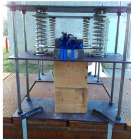
**Abbildung 2.** Modelle aus der Baudynamik-Vorlesung: Tilger für eine kleine Stahlbrücke für Demonstrationszwecke, der im Rahmen eines Semesterarbeit dimensioniert und gebaut wurde (IMAC)
