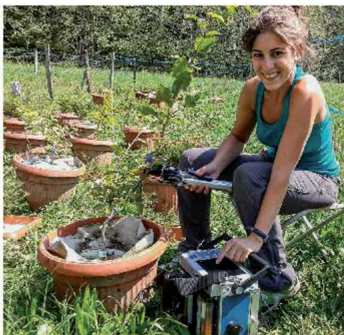
Fig. 1: Maria Paula Sanginés de Cárcer, doctorante au laboratoire ECOS de l'École polytechnique fédérale de Lausanne, mesurant la photosynthèse des arbres.
