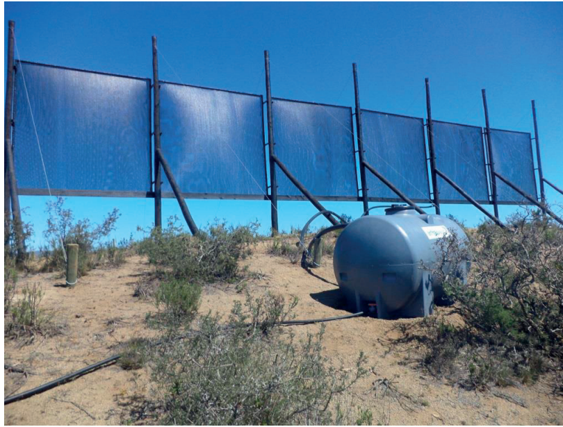
Figure 7.6 Atrapaniebla in the Atacama desert, Chile. Source: unaltoeneldesierto.cl.
