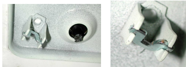
Figure 5. Supports du plateau du pèse-personne, par cavaliers.
