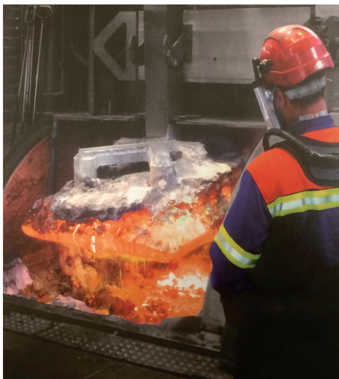
Figure 1.4 – Changement d'anode dans une cuve d'électrolyse. Le bain cryolithique à très forte température est visible sous l'anode (RIO TINTO ALCAN)
