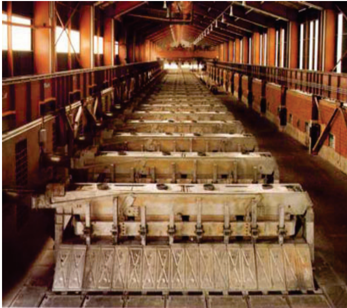
Figure 1.2 – Haut : Les conducteurs et le parcours du courant. Bas : Halle de plusieurs cuves d'électrolyse (source : agal.fr)
