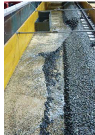
Figure 8 : Impact sur la banquette de ballast des écoulements sur la piste rétrécie sous un pont-route.
