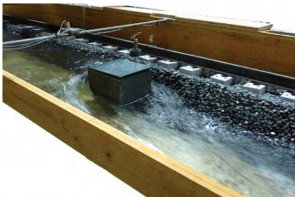
Figure 7 : Vue du phénomène autour d'un regard de collecteur drainant.
