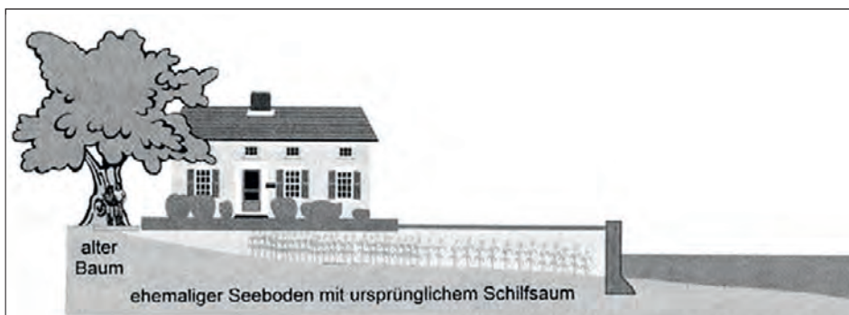
Figure 6: Schéma de la conquête type des rives lacustres, la plupart du temps en avançant sur le fond à faible pente vers le lac par remblayage avec construction d'un mur et/ou pose d'enrochements (tiré de ZSL 2006).
