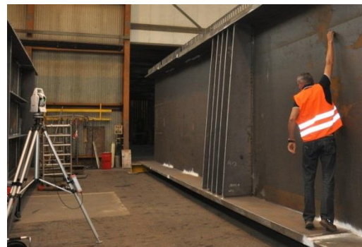
Figure 13: Illustration de mesure par Laser Tracker sur la poutre T10
