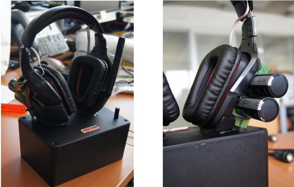
FIGURE 4.28 : Prototype de charge rapide et alimentation hybride d'un système audio sans fil
