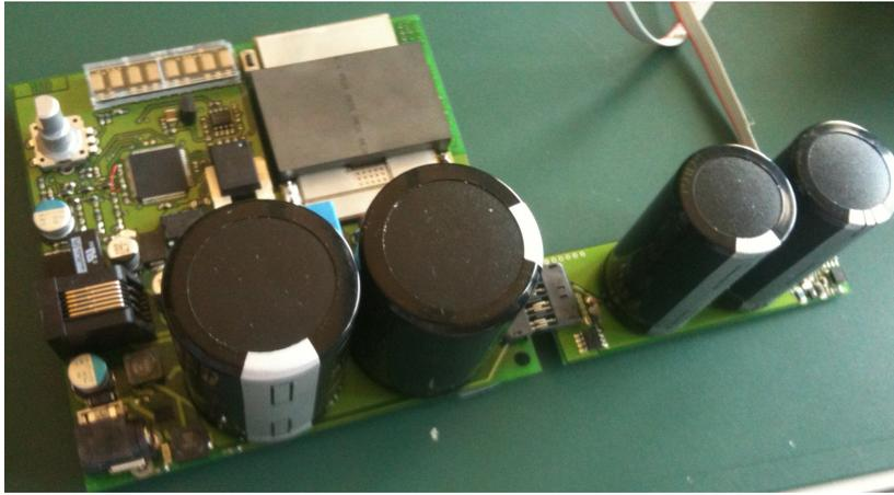
FIGURE 4.24 : Convertisseur de charge rapide : chargeur (à gauche) et application (à droite)
