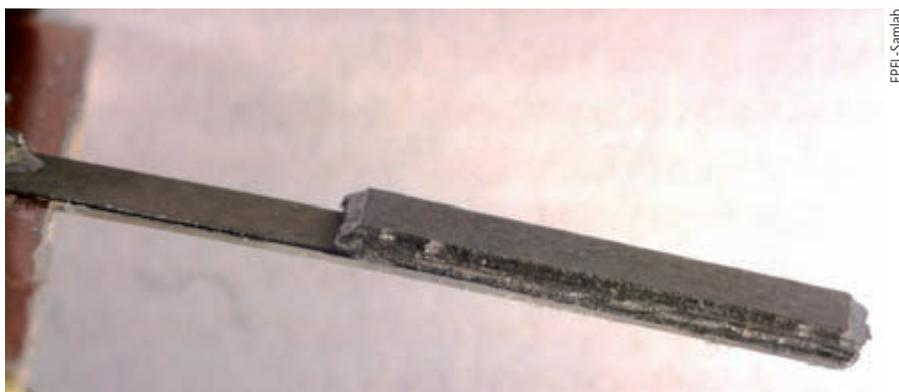
**Figure 6** Récupérateur piézoélectrique d'énergie de vibrations mécaniques fabriqué sur un substrat souple (PEN ou polynaphtalate d'éthylène, 15x3 mm<sup>2</sup>) par laminage d'une feuille piézoélectrique de PZT et ajout d'une masse en tungstène pour diminuer la fréquence de résonance à 105 Hz. Une puissance de 3,6 µW peut être générée sous une accélération de 0,5 g [7].
