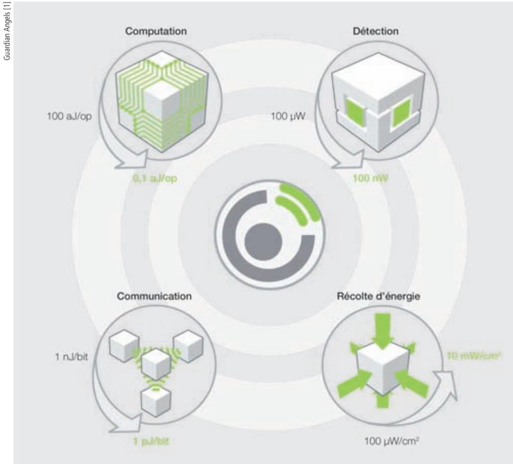
**Figure 2** Les nouvelles technologies de détection, de computation, de communication et de récolte d'énergie, permettant de réduire la consommation d'énergie ou d'accroître le gain énergétique, sont à la base des éléments qui composeront les systèmes de systèmes GA. Un système d'opération spécifique et des techniques de communication et de sécurité des données (cercles concentriques) seront combinés aux composants matériels pour la réalisation de ces GA.
