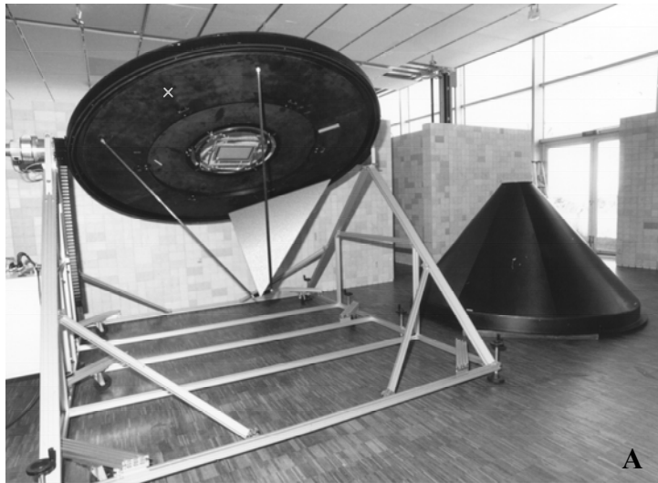
Fig. 2. Photogoniomètre bidirectionnel développé au LESO-PB / EPFL. A Illustration de l'appareil. La caméra CCD (absente sur la photo) est indiquée par une croix. B Rotation du plateau principal et du porte-échantillon.
