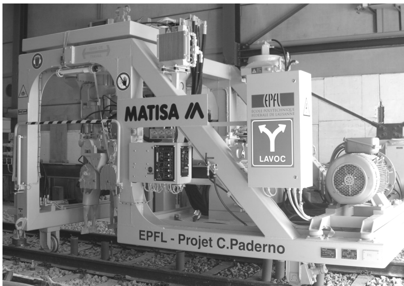
Figure 5.15 : Le véhicule de bourrage utilisé dans le cadre de la thèse
