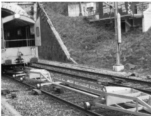
Figure 5.7 : Véhicule CFF pour la mesure de l'affaissement des voies (CFF 2008)
