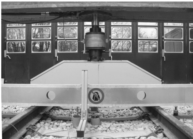
Figure 6.14 : Setup des essais de trafic sur la section à infrastructure rigide
