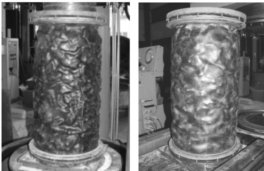
Figure 5.6 : Spécimen de ballast avant et après un essai triaxial.
