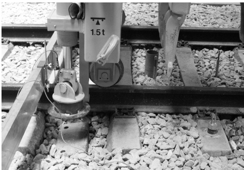
Figure 5.16 : Système et mesure du relevage de la voie
