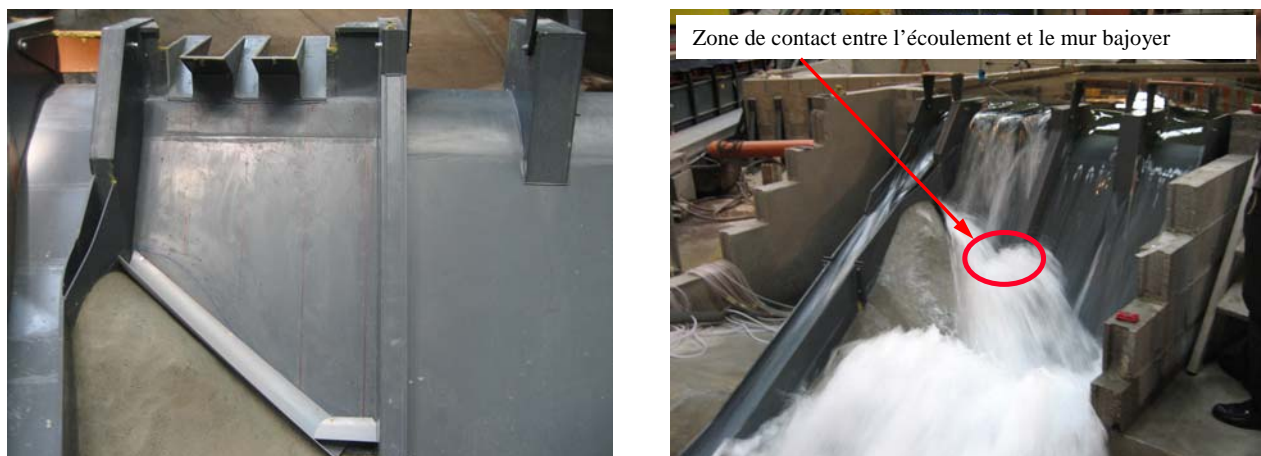
Figure 5 : Vue aval du PK-Weir avec la gouttière, à sec (à gauche) et en situation de crue (à droite).
