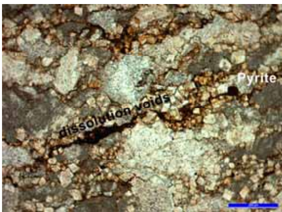
Abb. 12: Dünnschliff einer pyritreichen stratigraphischen Initialfuge: schön zu erkennen ist ein Pyrit-Kristall und von diesem ausgehend ein mäanderartiger Lösungshohlraum (Dünnschliff aus der Schichtfuge vgl. Abbildung 11).
