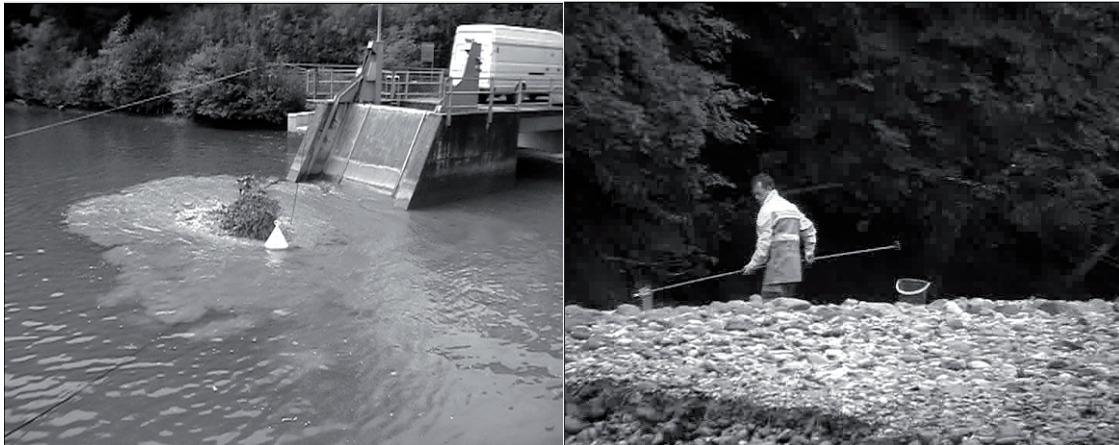
Abb. 6: Das vor den Einlauf gepumpte Wasser-Sedimentgemisch anlässlich der Testbaggerung (links) und Personal der SAK bei der Entnahme einer Wasserprobe in der Sitter, rund 300 m unterhalb des Eintritts des Unterwassers in den Fluss (rechts).
