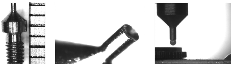
Figure 2.23 : Prototype de préhenseur par capillarité développé par Lambert (la distance entre graduation est de 1mm) [Lambert06].
