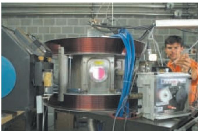
*Installation d'implantation de couches de diamant*
