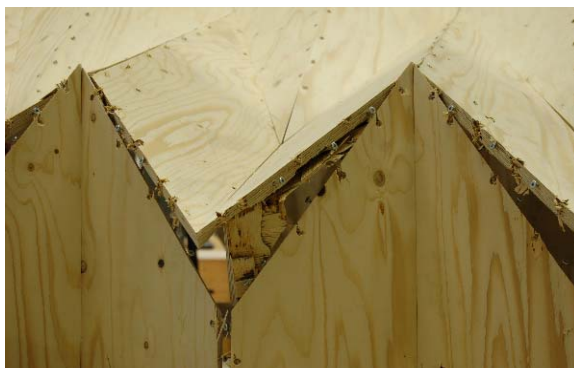
Fig.31 Prototyp: Aufreissen der Verbindung
