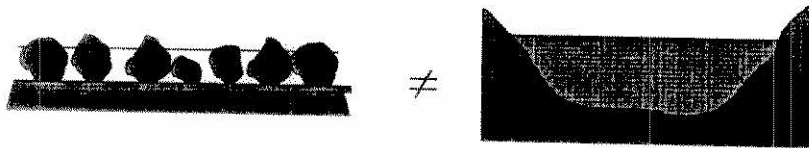
Figure 7 : Différences dans la géométrie d'un profil entre l'écoulement dans une macro-rugosité et un écoulement classique de l'hydraulique
