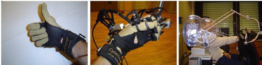
Figure 2. Les périphériques de la station haptique : à gauche, le CyberGlove™ ; au centre, le CyberGrasp™ ; à droite, le CyberForce™ et le CyberTrack™
