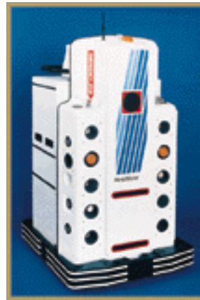
Fig. 3: Helpmate, ein Roboter der in Spitälern Transportaufgaben übernimmt.
