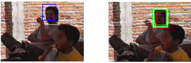
FIG. 3: Suivi de la région délimitée par le cadre blanc dans l'image de gauche : les particules associées aux cadres verts devraient avoir une plus grande probabilité que celle associée au cadre rouge.
