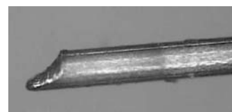
Fig. 8.9: Electrode de \text{Ø}149\ \mu\text{m} après l'usinage d'un côté du carré
