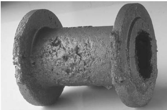
Fig. 2.5: Beispiel für Gasblasen [IfG - DK 2005]
