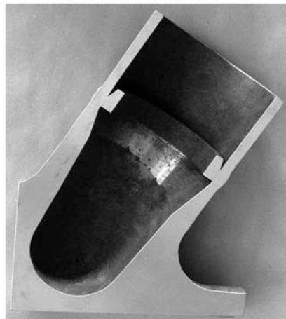
**Fig. 3.28:** Polierte Schnittfläche eines Knotens der Serie B
