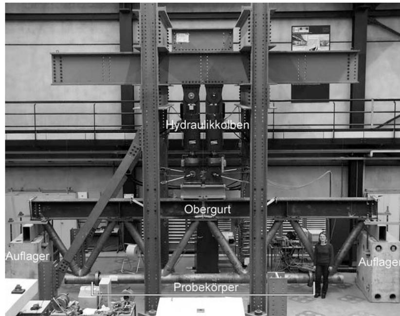
Fig. 3.9: Versuchsaufbau: Probekörper und Versuchsrahmen
