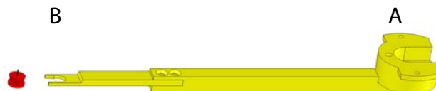
FIG. 4.21: Échangeur de pointe. Le côté A permet de le fixer sur le manipulateur, le côté B tient la pointe
