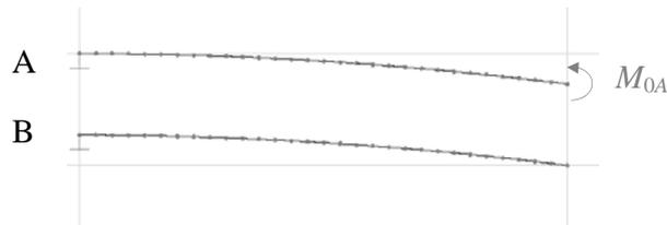
Abbildung 45: Aufatmen eines Kragträgers; Rückstellmoment  $M_{0A}$  wirkt auf den Ersatzträger A
