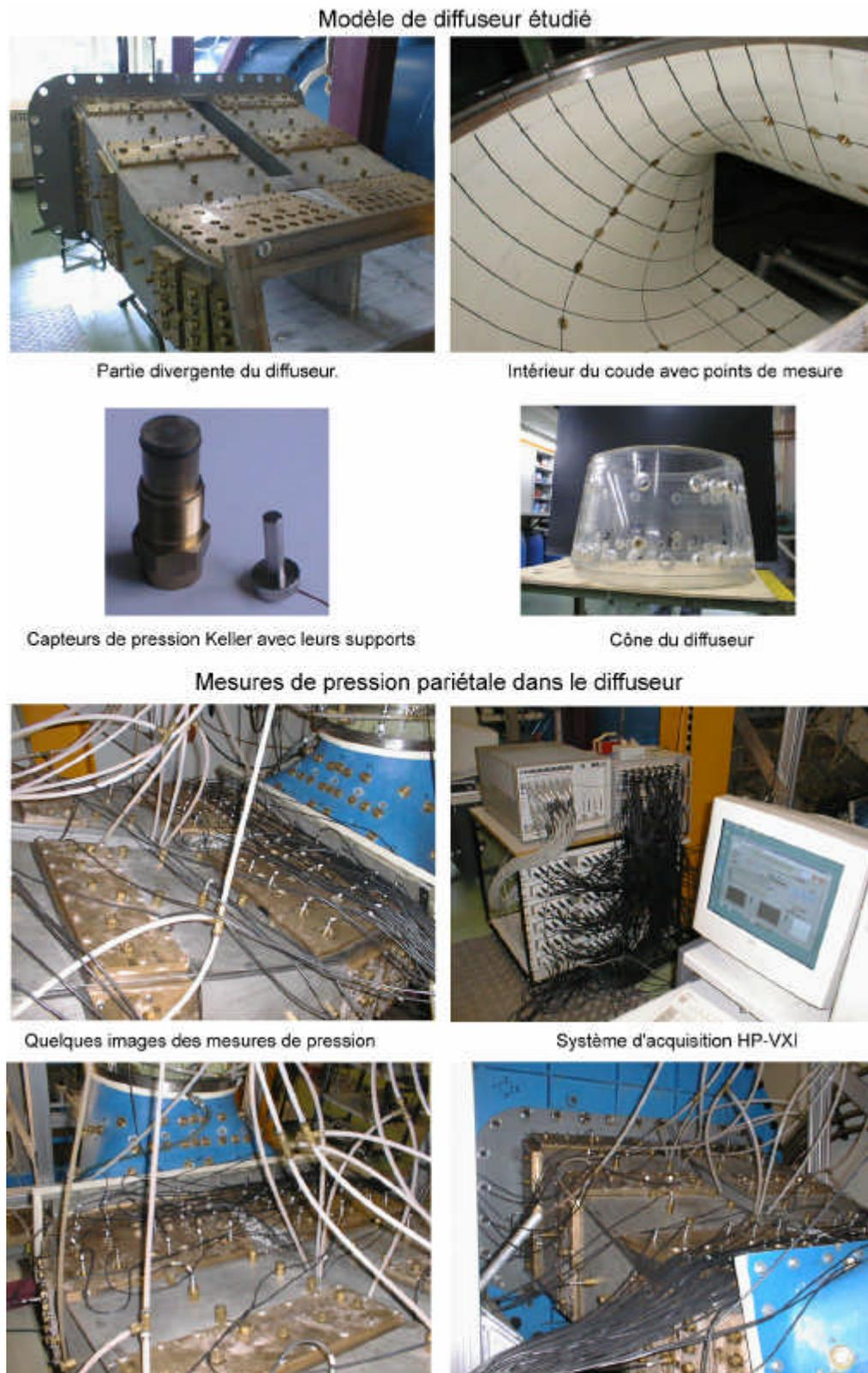
FIG. IV.12.29: Equipement de mesures de pression à la paroi du diffuseur.
