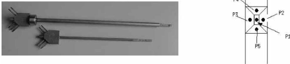
FIG. III.7.1: Sondes de pression stationnaire à 5 trous.
