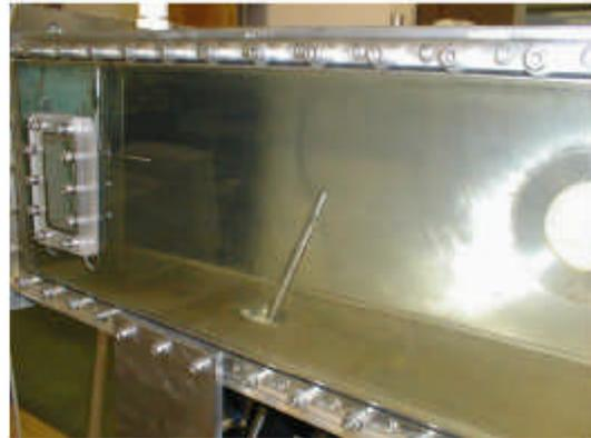
Sonde dans le tunnel hydraulique.
