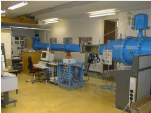
Tunnel hydraulique d'étalonnages du LMH.
