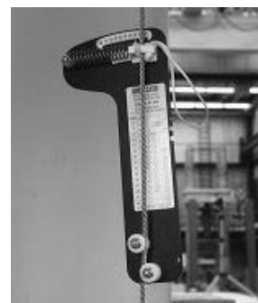
Figure 3.32: Tension Gauge® mis en place sur un câble
