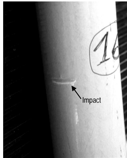
Figure 3.12: Endommagement d'une barre en Fiberline créée par un choc
