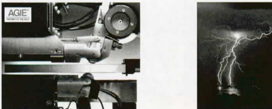
FIG. 7.1: L'électroérosion à fil est l'un des procédés d'usinage les mieux adaptés à la fabrication de structures flexibles. L'enlèvement de matière est provoqué par des décharges électriques (éclair sur les bords du lac Léman, 1999).
