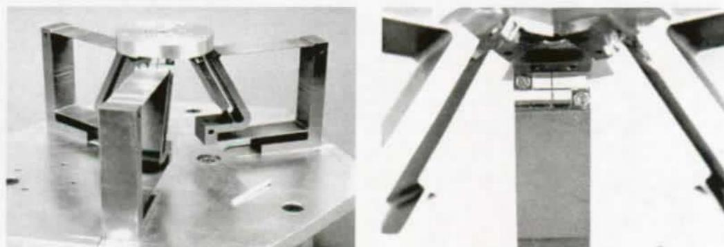
FIG. 11.9: Structure mécanique du robot Orion et détail de l'une de ses trois rotules flexibles rapportées. Un ressort de compression monté au centre de la structure précharge les rotules en traction, ce qui évite tout risque de flambage.
