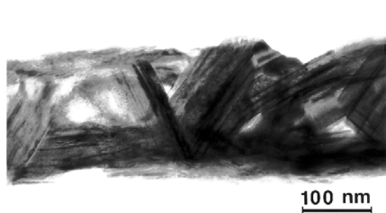
Fig. 7.2 Coupe transverse TEM d'une couche mince de WS_2 recuite avec du Ni à 750°C.
