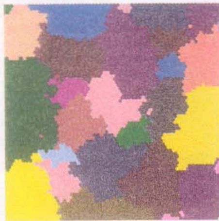
Fig. 4.41 : Extrait d'une microstructure obtenue par une simulation de Monte Carlo avec une probabilité de transition élevée (calcul N°3).
