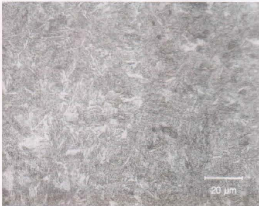
Fig. 3.27 : Microstructure au coeur de la pièce (environ 6 mm sous la surface).
