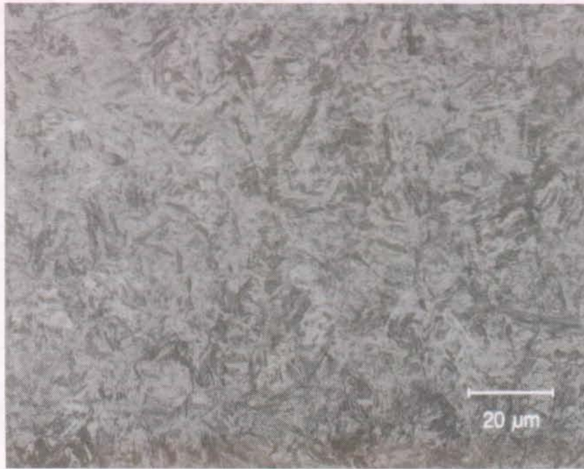
Fig. 3.26 : Microstructure dans la couche durcie.
