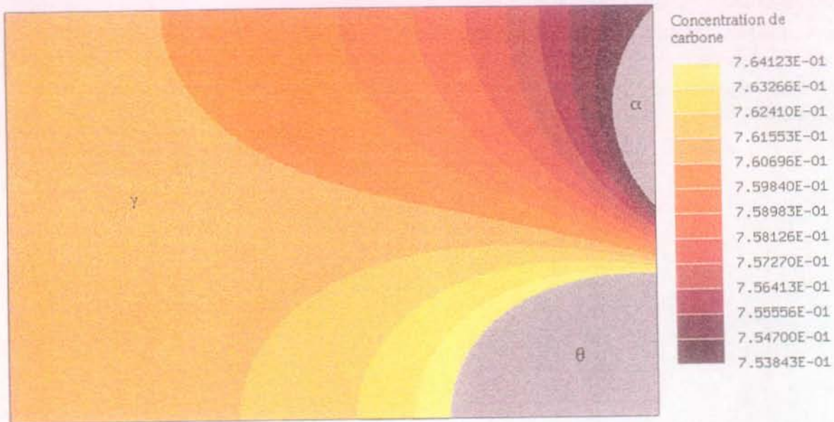
Fig. 4.13 : Solution du 1 er modèle analytique de Speich ( \Delta T = 1^\circ\text{C} , \lambda = 0.5 \mu\text{m} , D = 1.4 \cdot 10^{-12} \text{ m}^2/\text{s} ).
