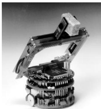
Figure 22: Robot Khepera dans la configuration utilisée pour les expériences collectives: la base est munie de 8 capteurs de proximité et la pince permet de saisir des objets (photo A. Herzog)
