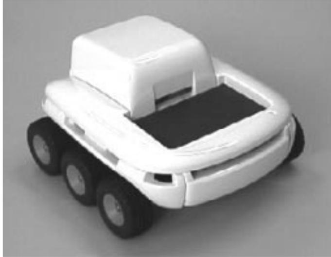
Figure 20: Le robot Koala mesure environ 30 x 30 x 20 cm
