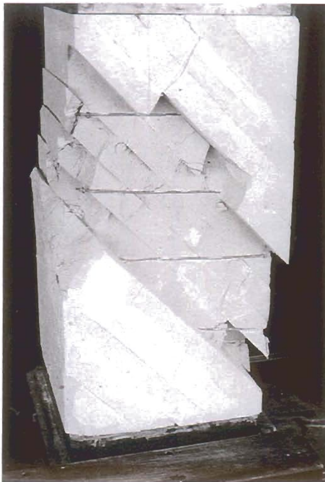
Figure 4.15 : Vue après rupture d'un modèle en plâtre de la série PL - les barres ne se sont pas rompues
