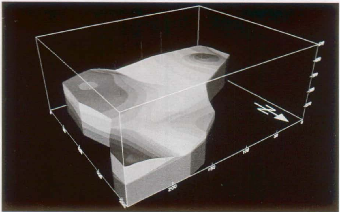
Figure 7.25 : Utilisation de l'exagération verticale et des bandes de niveau pour mettre en évidence la topographie du soubassement du fluvio-glaciaire 3. Les sondages sont représentés en bleu. L'épaisseur des bandes de niveau est de 1 mètre (exagération verticale 2x, légende voir figure 7.26, échelle en mètres)
